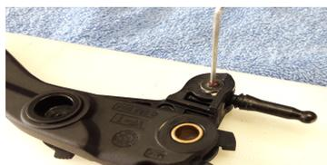
Lösen der Madenschraube u. herausdrehen des Kegelzapfens.
